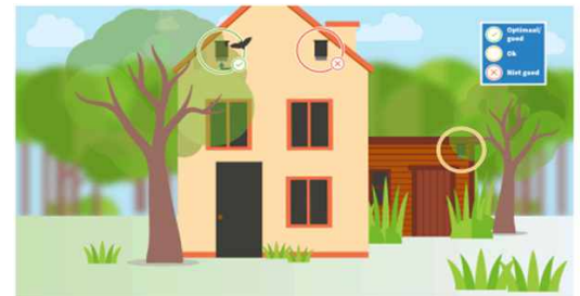
Figuur 3.3: Schematische weergave van hoe bij het aanbieden van nieuwe verblijfplaatsen rekening moet worden gehouden met de aanwezigheid van opgaande begroeiing.
